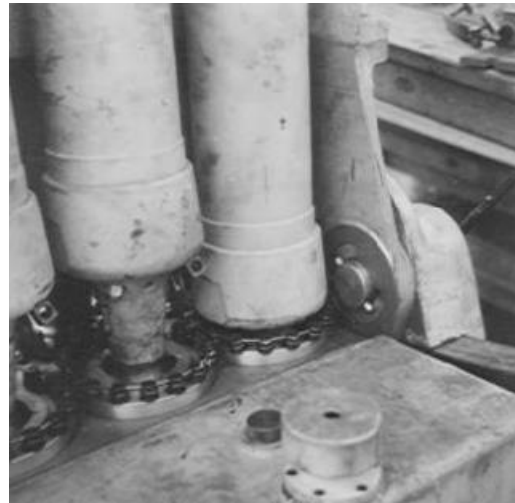
Rohrrücklaufbremsen: Versagen eines Vorholers auf Höhe der Ladebühne
