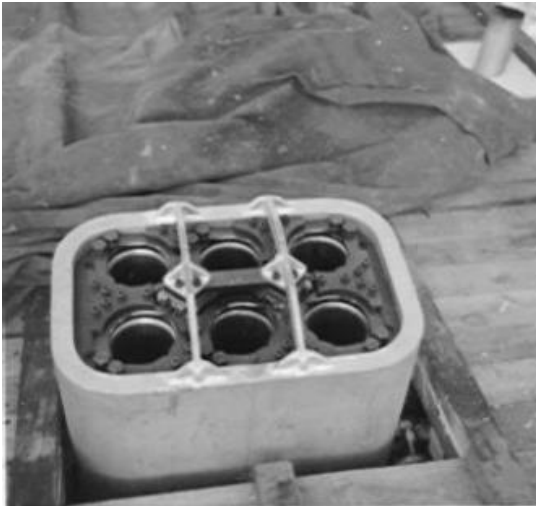
Schiessversuche 12 cm Mehrfachminenwerfer SIG in Thun Rohrbündel mit "Zangenplatte"
