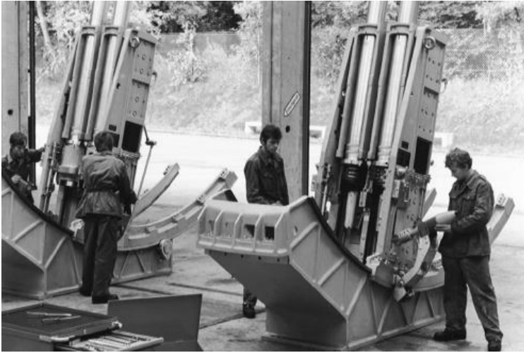
Vormontage und Funktionskontrolle von zwei 12 cm Festungs-Mw 59 in der Eidgenössischen Waffenfabrik Bern
