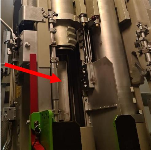
4. Belüftungstopf stirnseitig leicht einfetten mit Rad- und Wälzlagerfett)
