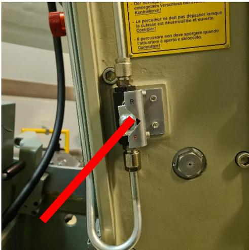
2. Steuerstange durch betätigen der Gabelstange nach oben schalten. Dies geschieht, indem wir mit dem Kunststoffhammer den Stift, welcher im Normalfall mit dem Einwurfhebel betätigt (gedrückt) wird, mit einem leichten Schlag hineinschlagen.
