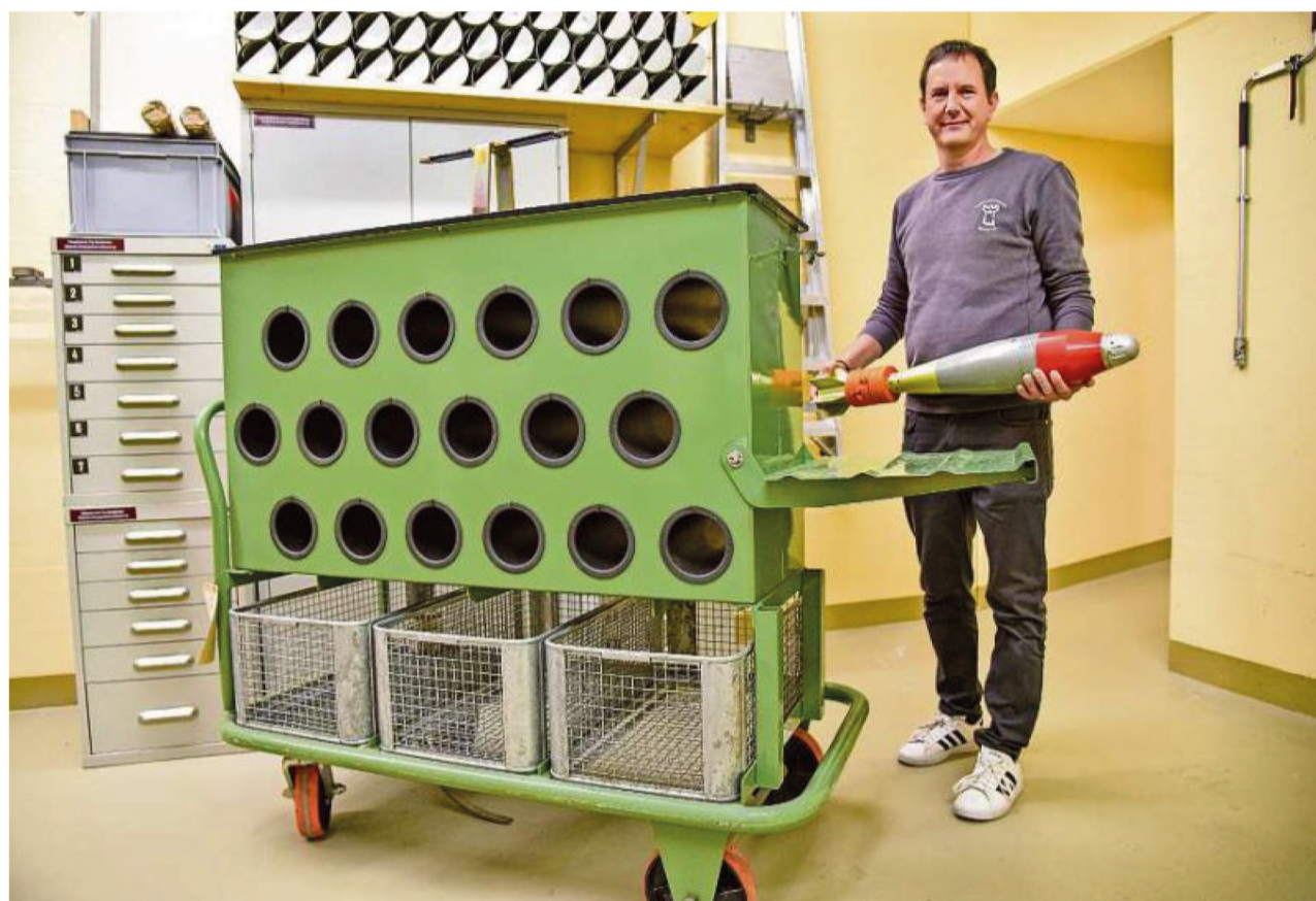
Zurück in den Kalten Krieg: Markus Diethelm zeigt den sogenannten Laborierwagen, auf dem die verschiedenen Granaten für den Festungsminenwerfer schussfertig gemacht wurden. Bilder: Jano Felice Pajarola
