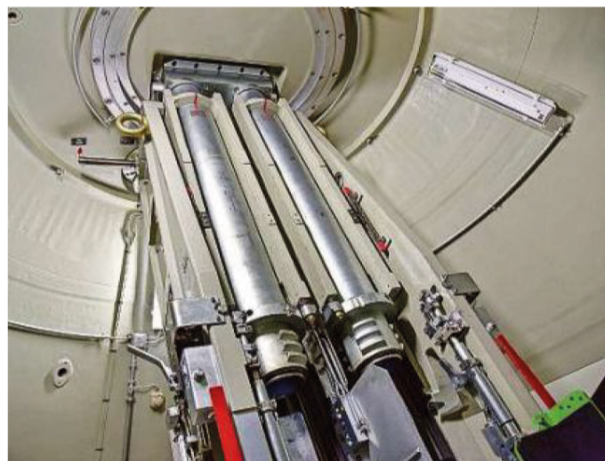
Unter gepanzertem Deckel: Der Festungsminenwerfer 59 verfügt über zwei parallele Abschussrohre mit Druckluftantrieb (links). Eine ganz andere Atmosphäre herrscht im 46 Jahre älteren Weltkriegsbunker Laseaz (rechts).
