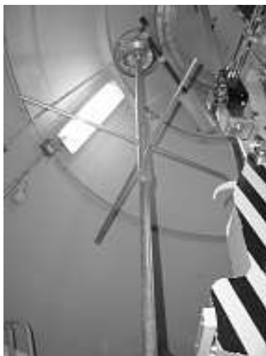
Figur 18 und Figur 19 - Öffnungsschlüssel für Notöffnung zu Panzerdeckel
