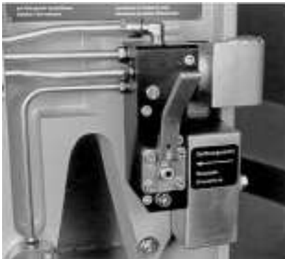
Figur 47 - Öffnungsventil mit angesetztem Schlüssel
